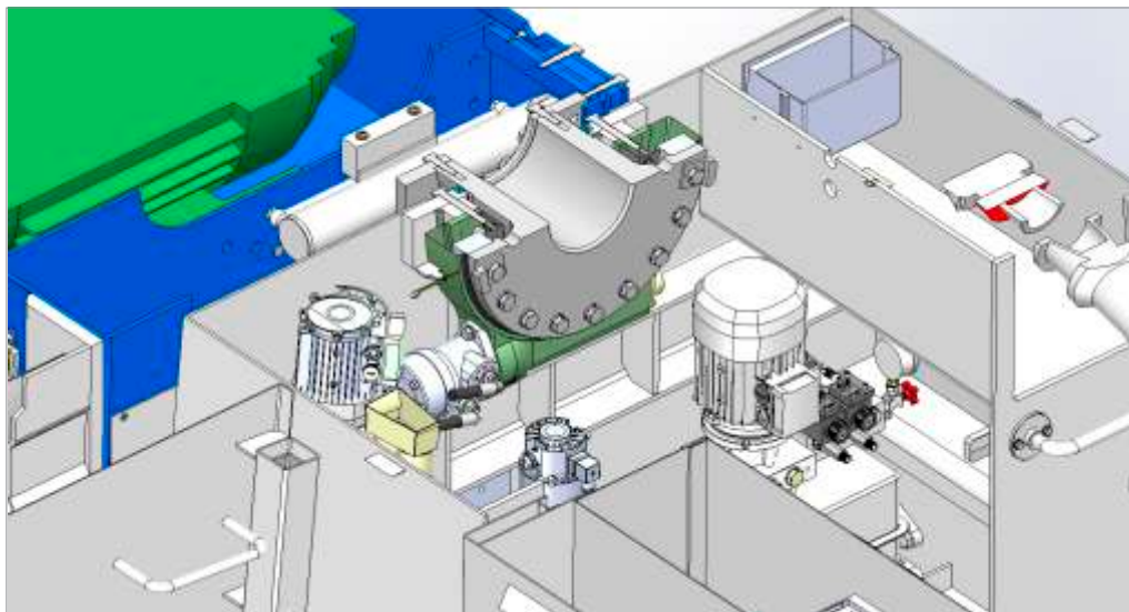
Ralla per la rotazione della testa operatrice / Center plate for the head rotation
